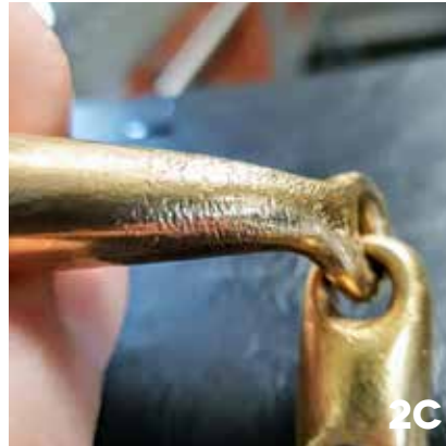
Fig 2 c en d: slijtage bitten ten gevolge van 'kauwen op het bit'.
